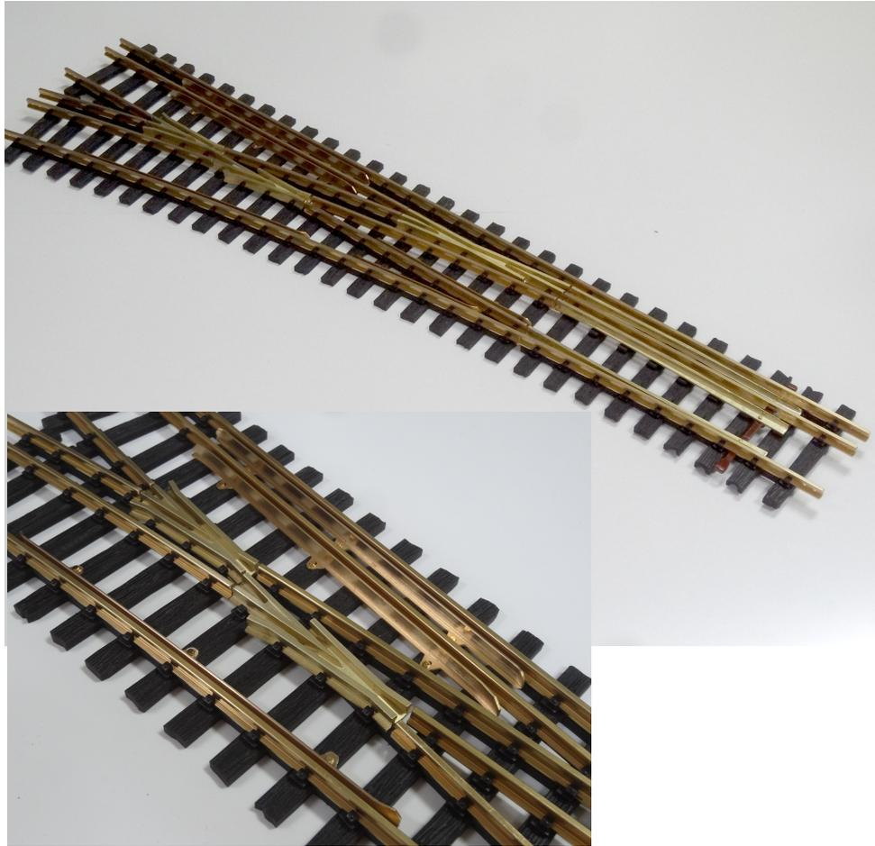
Für das Montieren der Schienenstühlchen beachten Sie bitte, dass die Schienenstühlchen an Herzstück, Radlenker, Zungenprofilauflagen etc. halbiert oder deren Boden bis zur Klammer an eng nebeneinander sitzende Schienenstühlchen gekürzt werden muss.
